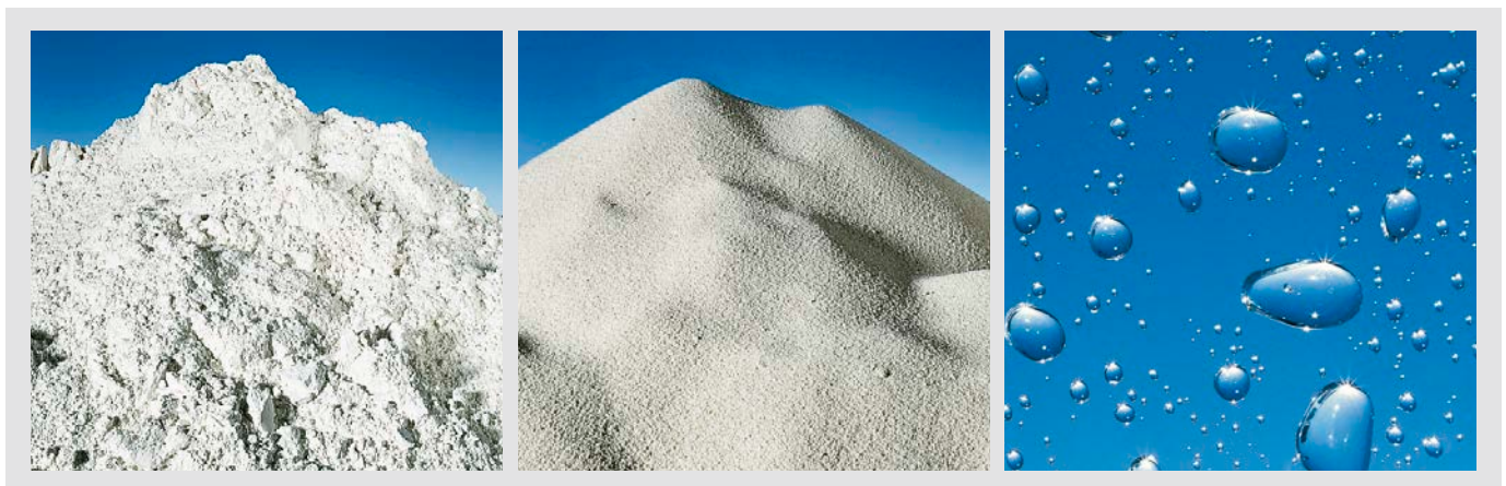
Ausgangsstoffe zur Herstellung von Kalksandsteinen: Kalk – Sand – Wasser – sonst nichts
