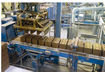
Nach dem Mischen erfolgt das Pressen der Rohlinge
